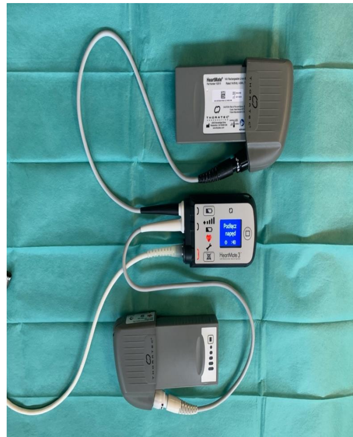
Sterownik HeartMate 3 podłączony do baterii. Fot. Jarosław Szymański, archiwum własne.
